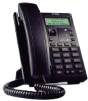
Teléfono IP 6863 2 líneas Display 128x48 LCD 2 puertos 10/100Mbps
